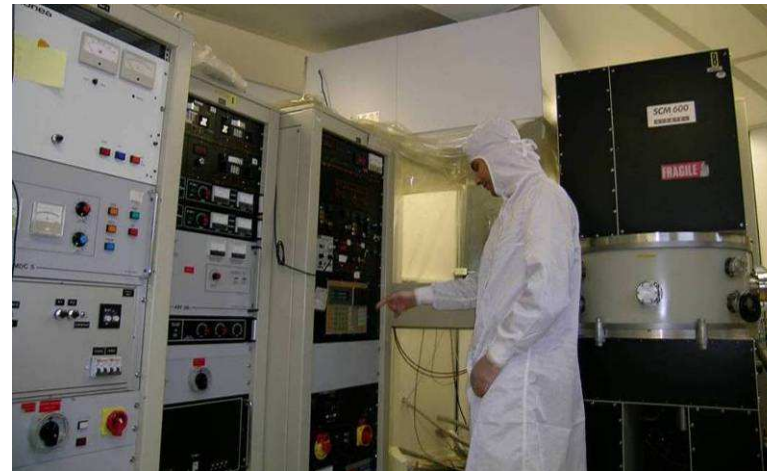
Alcatel 650: 4 cathodes dépôt sur 100 cm 2 sur substrat chaud 20°C <T s <700°C [Al, Nb, NbN, TaN, AlN, MgO,.]
