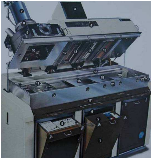
MRC 903: 3 cathodes, dépôt sur 1000 cm 2 [Nb, NbN, TaN, MgO,.]
