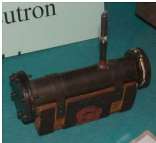
le générateur historique, enfin une relique non radioactive ! ( T_{1/2}({}^{210}\text{Po}) = 138 \text{ jours} )
