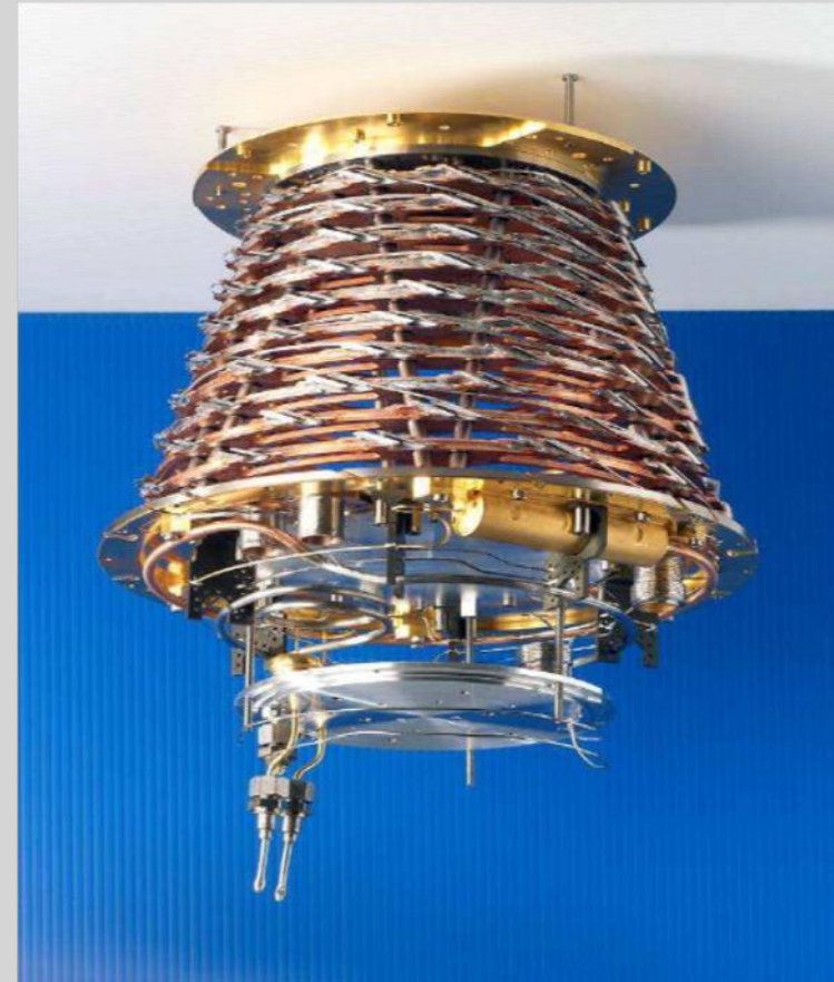
Refroidisseur en cycle ouvert de Planck
